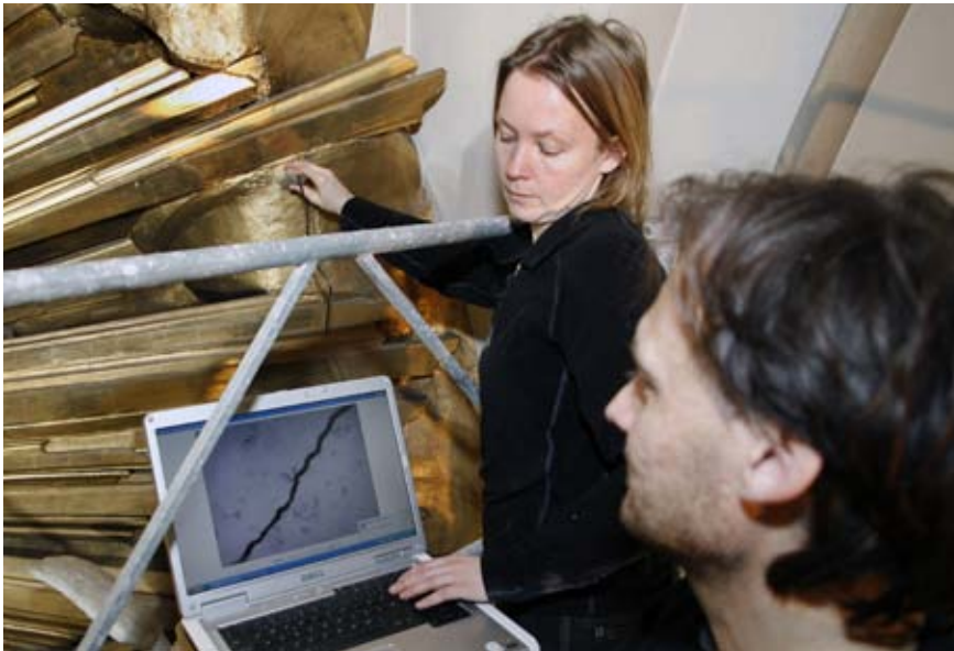
Artikelförfattaren och Alexander Eckert kontrollerar sprickor på en referensyta som är en altaruppsats av förgylld stucc. Foto: Hans Ekenstang.
